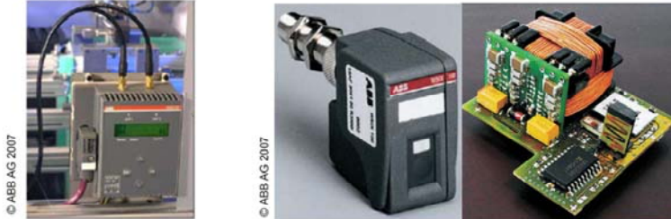
a) Eingabemodul mit Antennenkabeln und Feldbusstecker (FBP) b) Sensor mit Kommunikationsmodul (links) Elektronik des Kommunikationsmodul (rechts)
